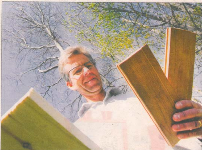
Värmebehandlat trä blir både rötbeständigt och formstabilt, berättar Harald Säll som i ena handen har en bit ljus asp och i den andra värmebehandlat virke av samma träslag. Av värmen får träet en brun ton, som liknar de tropiska träslagen. Foto: LARS-GÖRAN RYDQVIST
